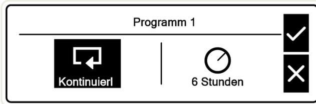
Durch Auswahl der Option Kontinuierlich stellen Sie sicher, dass sich das Neige-Deck kontinuierlich in der vom ausgewählten Programm vorgegebenen Reihenfolge von einer Seite zur anderen dreht.
