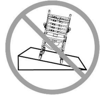
**ROLLENSPERREN SIND KEINE BREMSEN!** Verwenden Sie niemals die Rollensperren, um den Raz-ART beim Herunterfahren von Schrägen zu bremsen, da dies dazu führen kann, dass der Stuhl in Fahrtrichtung kippt.
