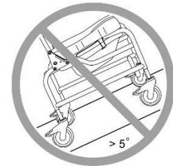
**Schieben oder ziehen Sie den Raz-CAT NICHT an einer Steigung oder Rampe nach oben oder unten, die eine Steigung von 1:12 (5 ° Neigung) überschreitet.**
