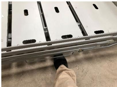
Der Abstand zwischen der Unterseite des Seitengitters und dem Boden beträgt ca. 120 mm
