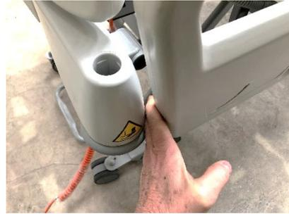
Der Abstand zwischen Stoßstange und gedämpftem Seitengitter beträgt ca. 8 mm
