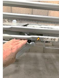
Der Abstand zwischen dem Drehgelenk und der unteren Leiste des Seitengitters beträgt weniger als 25 mm
