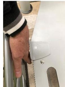
Der Abstand zwischen dem Kunststoffteil der Liegefläche, der die Matratze trägt, und dem Seitengitter beträgt ca. 25 mm
