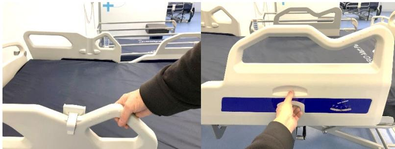
Klicken Sie zum Absenken des Seitengitters auf den grauen Kunststoffgriff in der Mitte des Gitters und lassen Sie ihn los. Die Absenkgeschwindigkeit wird mit Hilfe eines eingebauten Dämpfungsmechanismus reduziert.
