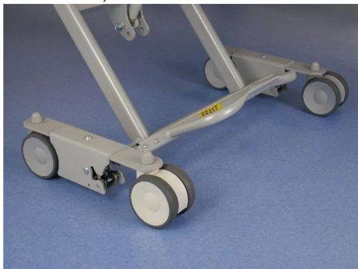
Stellen Sie sicher, dass Bremse und Lenkung bei stehendem Bett immer betätigt sind. Das Bett ist mit einem automatischen Bremssystem ausgestattet, wenn sich das Bett in der niedrigen Position befindet. In dieser Position ist es nicht möglich, die Bremsen zu lösen. Um die Bremsen zu lösen, muss das Bett mindestens 5 cm über die niedrigste Höhe angehoben werden (21 cm + 5 cm).
